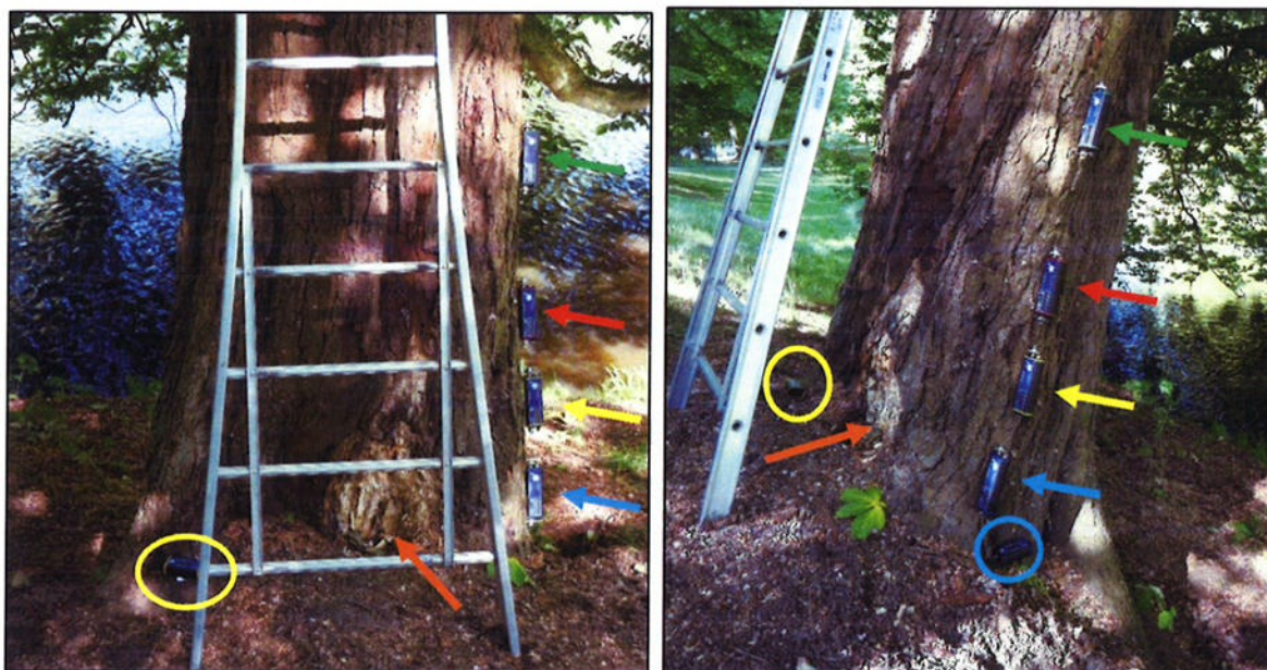
Foto 2: Links en rechts een beeld van de stamvoet met rotting (oranje pijl) en plaatsing van de sensoren. De elastometers zijn met een pijl aangeduid, de inclinometers met een cirkel. De kleur van de pijl en cirkel correspondeert met de kleurcode in tabel 2.
