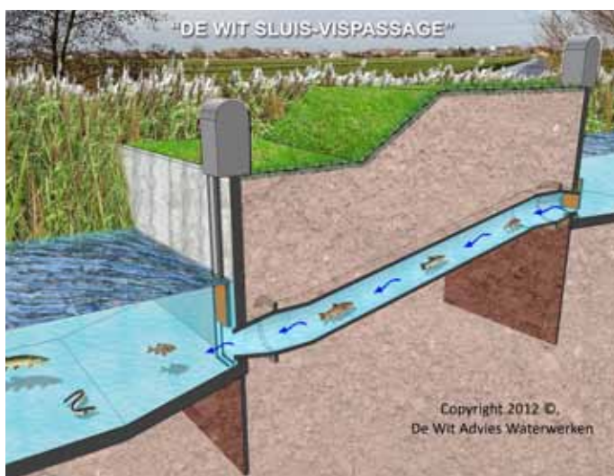
Figuur 16.2 | Schematische weergave van de De Wit-sluisvispassage.
