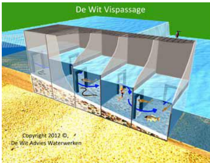
Afbeelding 2.6 De Wit vispassage. Bron Handreiking vispassages in Noord-Brabant
