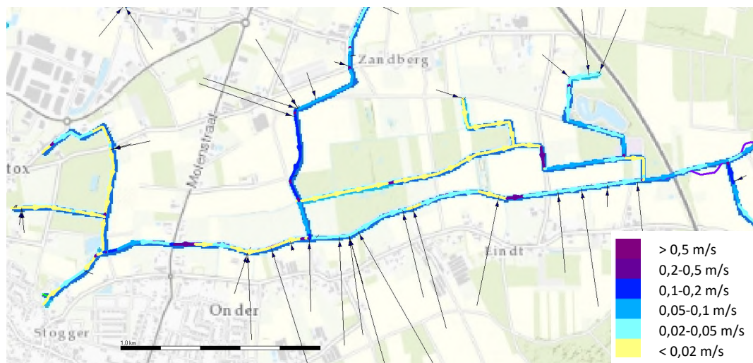
Figuur 3-13: stroomsnelheid in de bovenloop in de huidige situatie bij een Q30-zomerafvoer in de bovenloop
