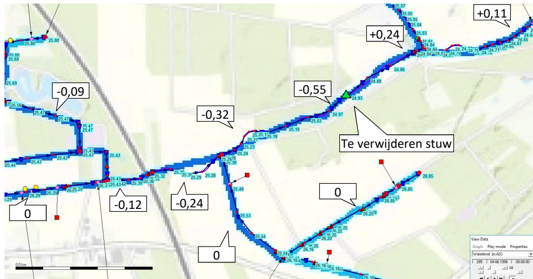
Figuur 4-41: Verschil in oppervlaktewaterstand tussen de huidige situatie met stuw en de ontwerpsituatie zonder stuw tijdens een zomerafvoer (Q10).
