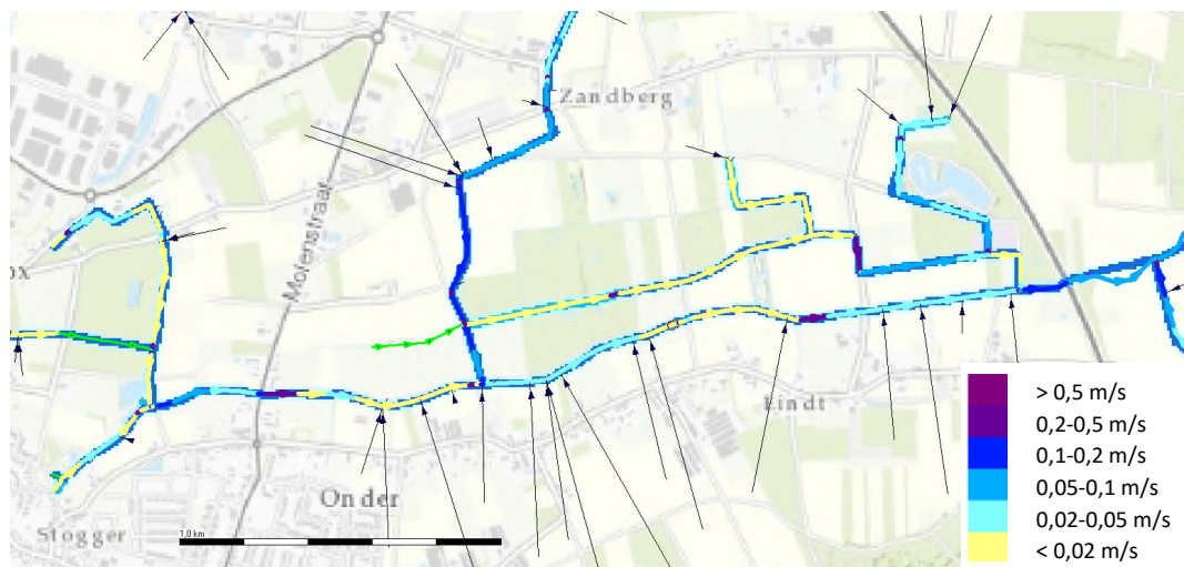
Figuur 3-14: stroomsnelheid in de bovenloop in de toekomstige situatie bij een Q30-zomerafvoer in de bovenloop
