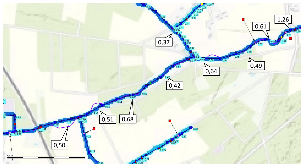
Figuur 4-14: Waterdiepte in de huidige situatie bij een Q50-zomerafvoer
