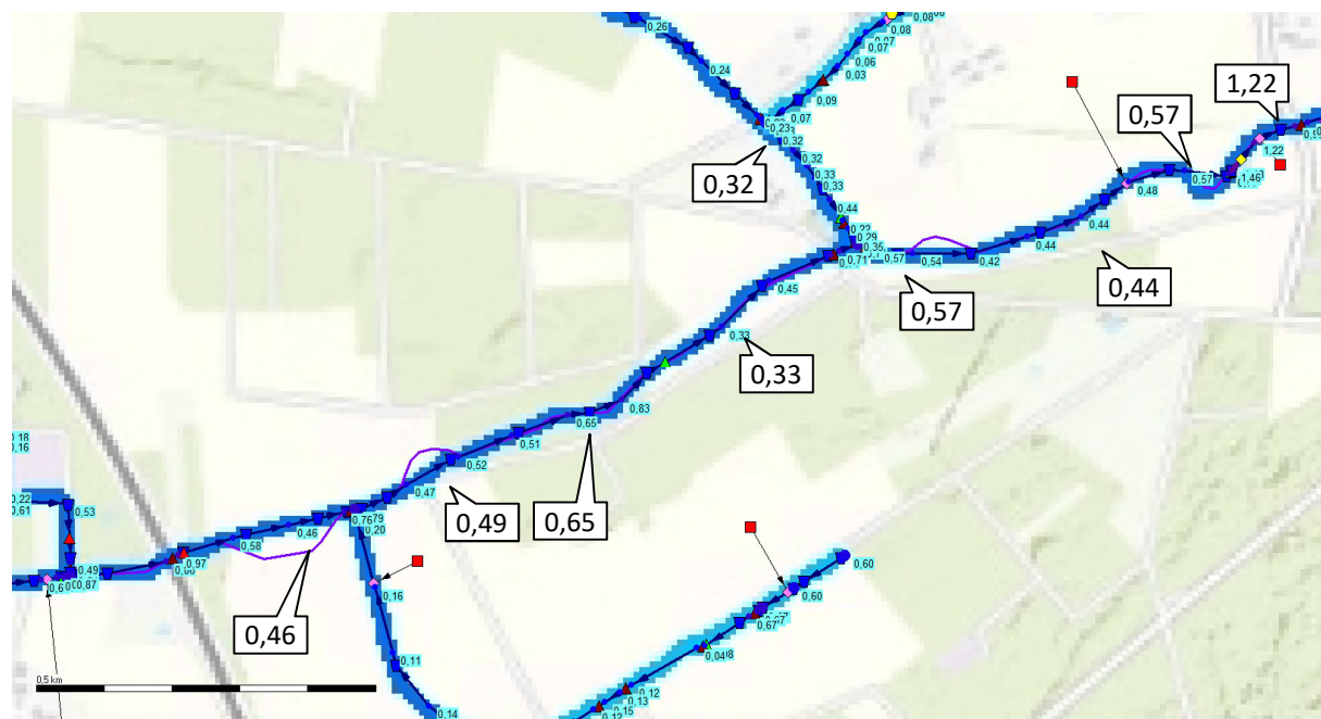
Figuur 4-13: Waterdiepte in de huidige situatie bij een Q30-zomerafvoer
