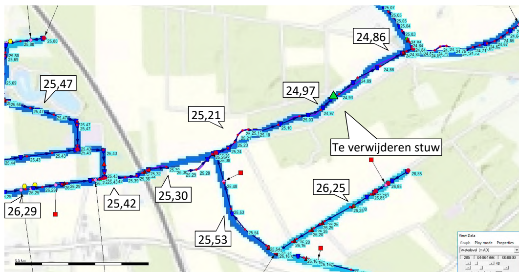
Figuur 4-39: Met SOBEK berekende oppervlaktewaterstanden t.o.v. NAP tijdens de zomerafvoer (Q10) voor de toekomstige situatie.
