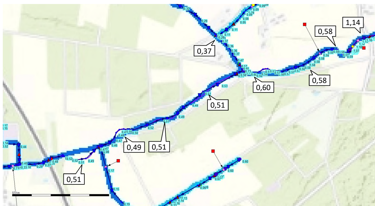
Figuur 4-16: Waterdiepte in de toekomstige situatie bij een Q50-zomerafvoer
