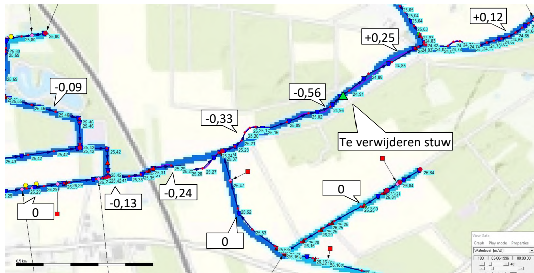
Figuur 4-40: Verskil in oppervlaktewaterstand tussen de huidige situatie met stuw en de ontwerpsituatie zonder stuw tijdens de basisafvoer (Q5).
