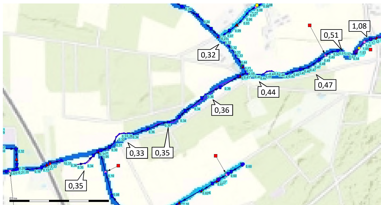
Figuur 4-15: Waterdiepte in de toekomstige situatie bij een Q30-zomerafvoer
