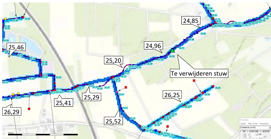
Figuur 4-38: Met SOBEK berekende oppervlaktewaterstanden t.o.v. NAP tijdens de basisafvoer (Q5) voor de toekomstige situatie.
