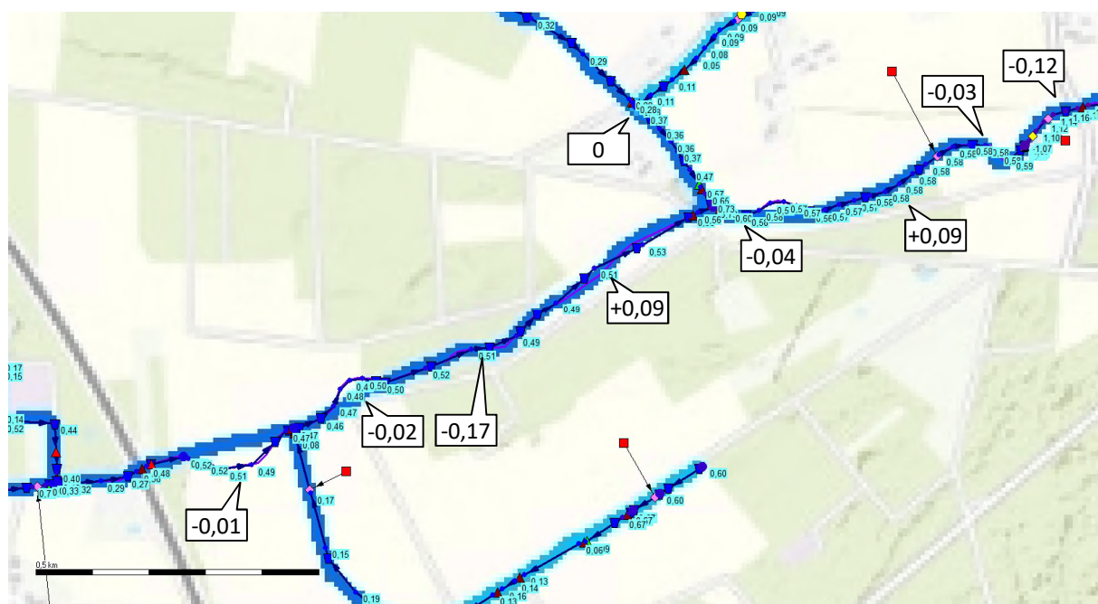
Figuur 4-18: verschil tussen de huidige en toekomstige in waterdiepte bij een Q50-zomerafvoer
