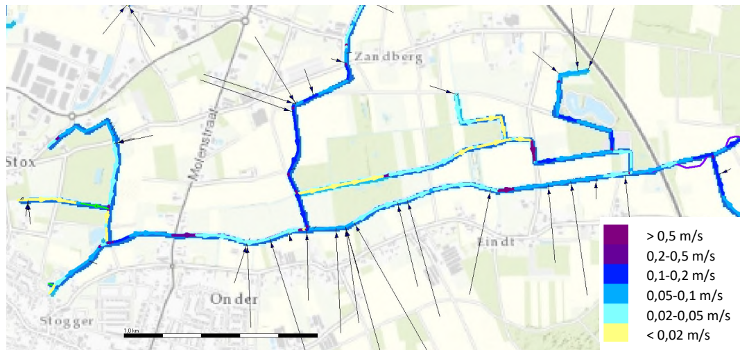
Figuur 3-15: stroomsnelheid in de bovenloop in de huidige situatie bij een Q50-zomerafvoer in de bovenloop
