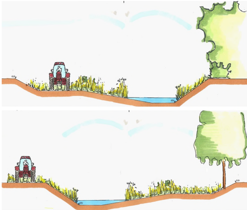
Figuur 4-5: Ontwerp dwarsprofiel middenloop
