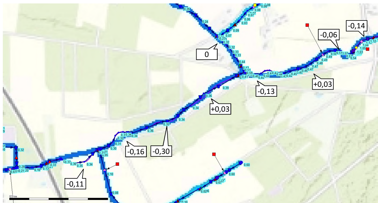
Figuur 4-17: verschil tussen de huidige en toekomstige situatie in waterdiepte bij een Q30-zomerafvoer
