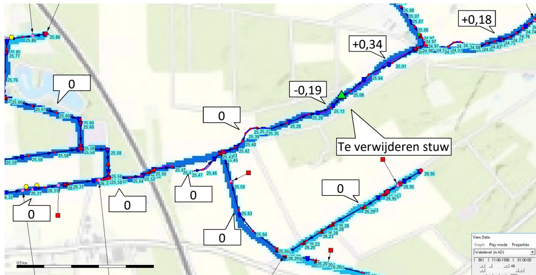
Figuur 4-43: Verschil in oppervlaktewaterstand tussen de huidige situatie met stuw en de ontwerpsituatie zonder stuw tijdens winterafvoer (Q50).
