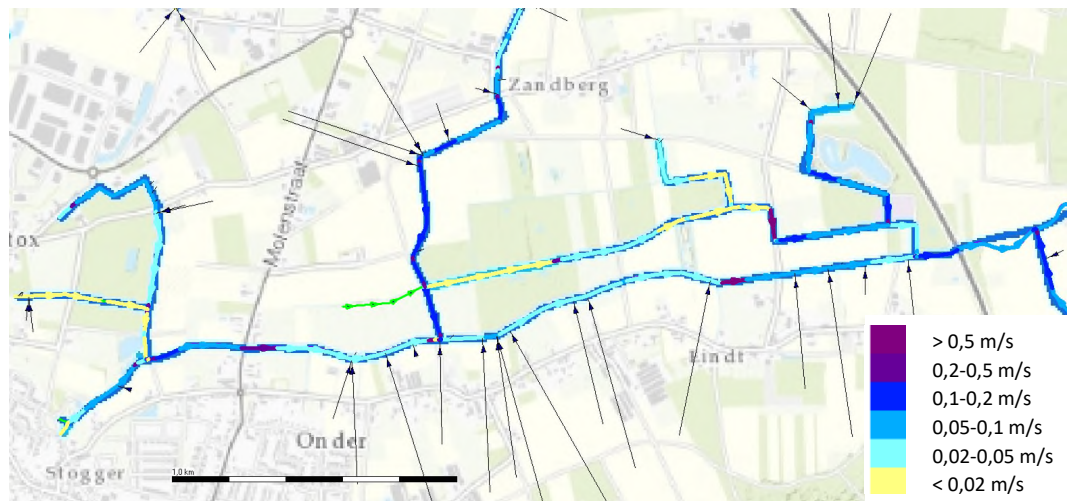
Figuur 3-16: stroomsnelheid in de bovenloop in de toekomstige situatie bij een Q50-zomerafvoer in de bovenloop
