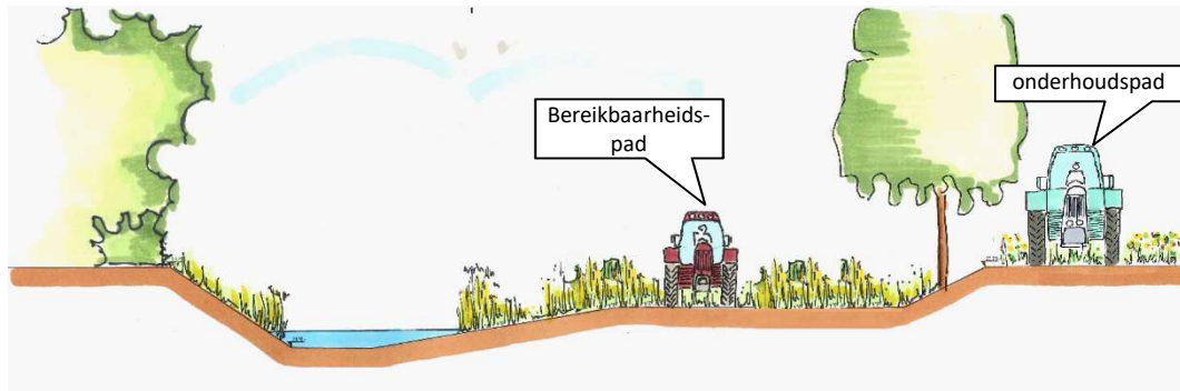
Figuur 6-9: Verschil onderhoudspad en bereikbaarheidspad
