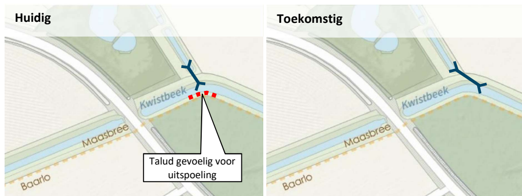
Figuur 4-20: Te vervangen duiker Dekeshorst
