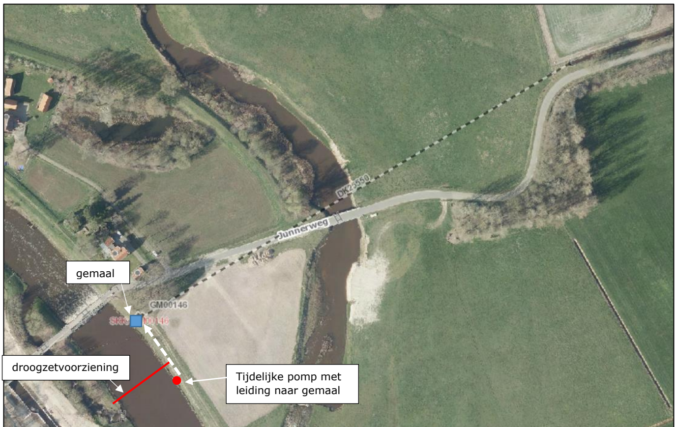
Figuur 19: Ligging gemaal en pomp tijdens werkzaamheden.
