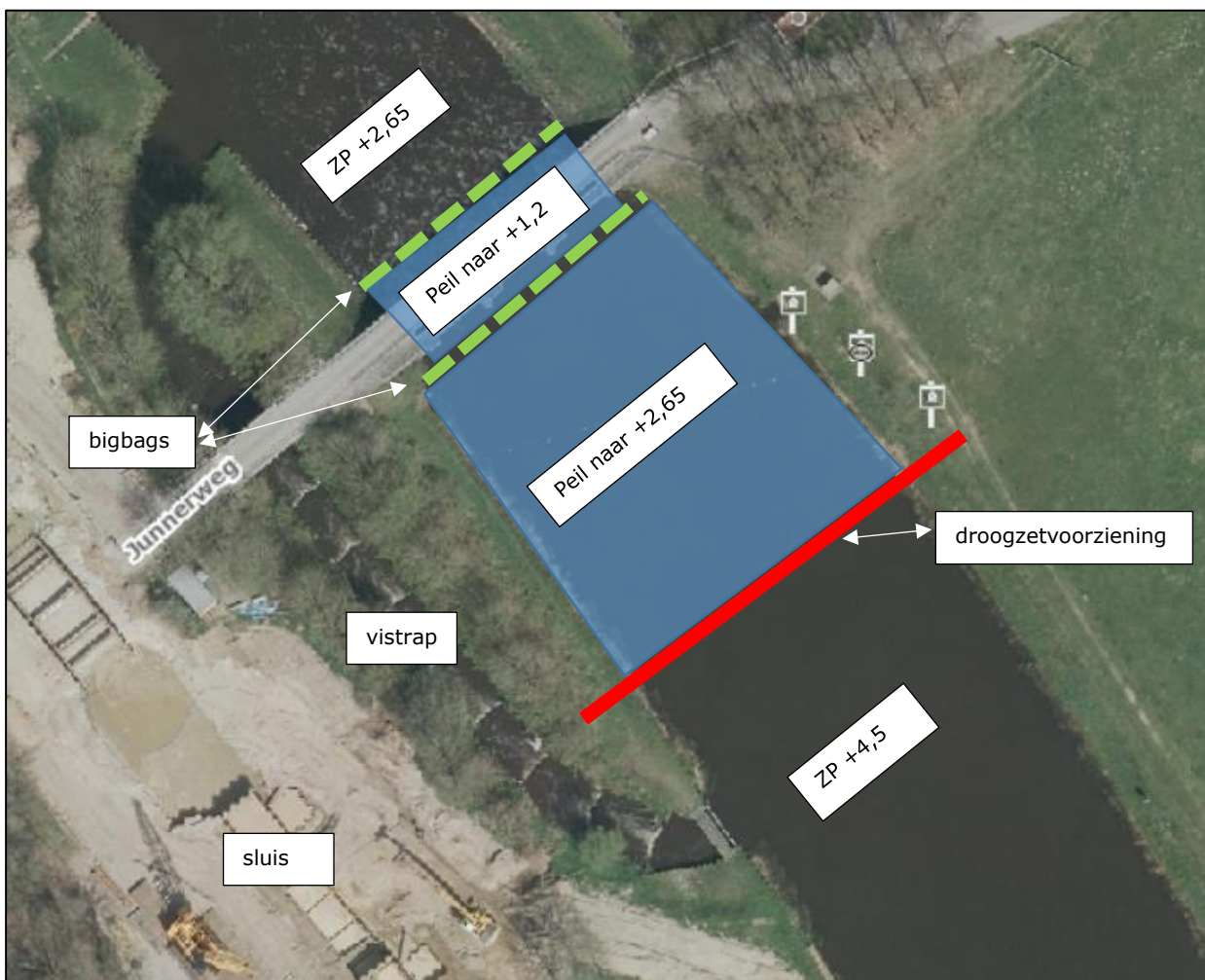
Figuur 20: Tijdelijke verlaging oppervlaktewaterpeil Vecht
