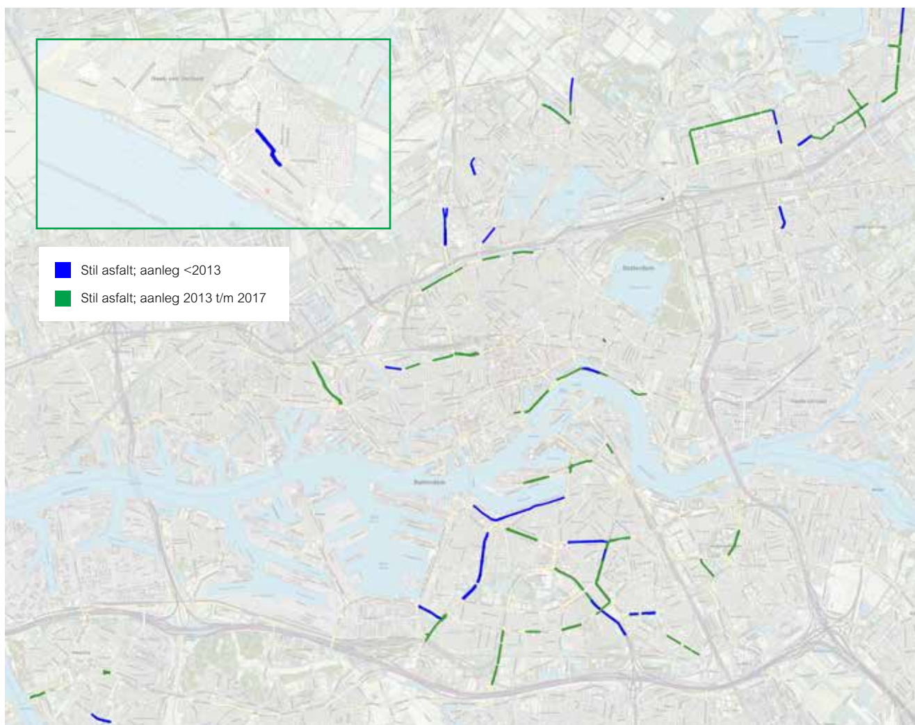
Stil asfalt in Rotterdam (blauw is aangelegd in de periode 2013-2018 en groen in de periode ervoor)
