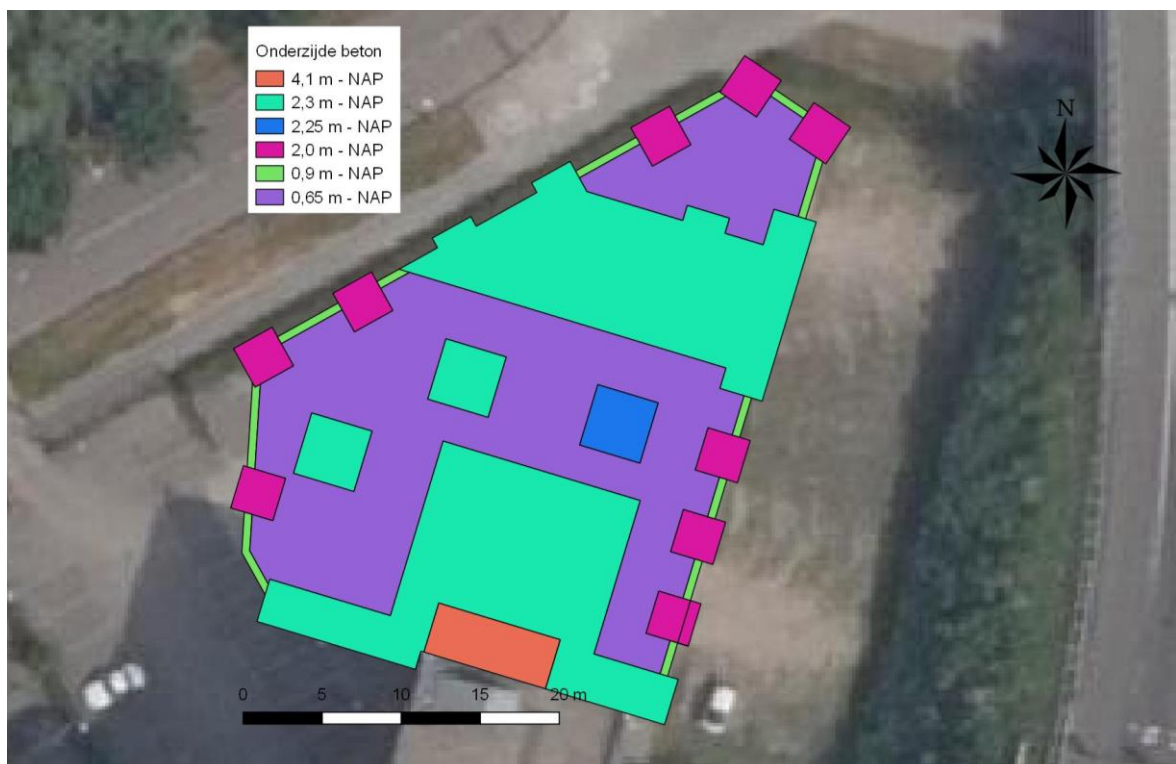
Figuur 1. Aanlegniveau betonconstructie.
