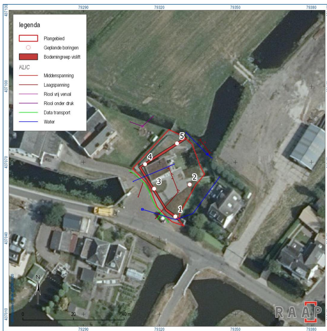
Figuur 10. De boorlocaties, kabels en leidingen en contour van de geplande bodemingreep geprojecteerd op een recente luchtfoto ( www.pdok.nl ).
