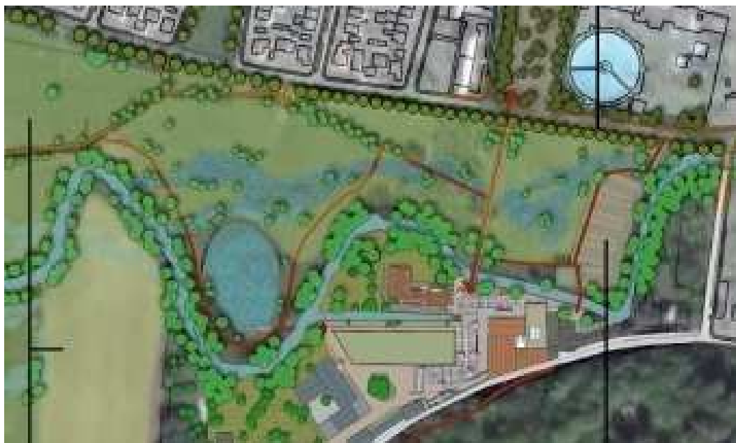
Fig. 8 Waterbergingsplan Gemeente Valkenburg ter hoogte van het Leeuw Brouwerijterrein. Er wordt ten noorden van het Leeuw Brouwerijterrein een brede verlaagde strook aangelegd bedoeld als waterberging en doorstromingsgebied bij hevige regenval
