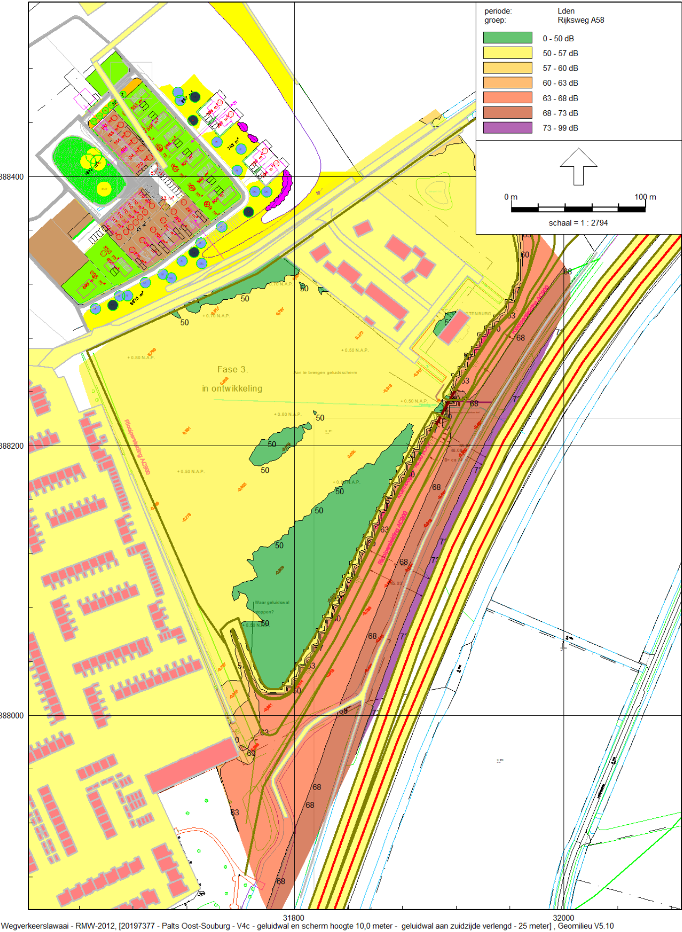
Figuur B1.3 | Geluidsbelastingcontouren vanwege de A58 bij geluidswal verlengd met 25,0 meter aan de zuidzijde
