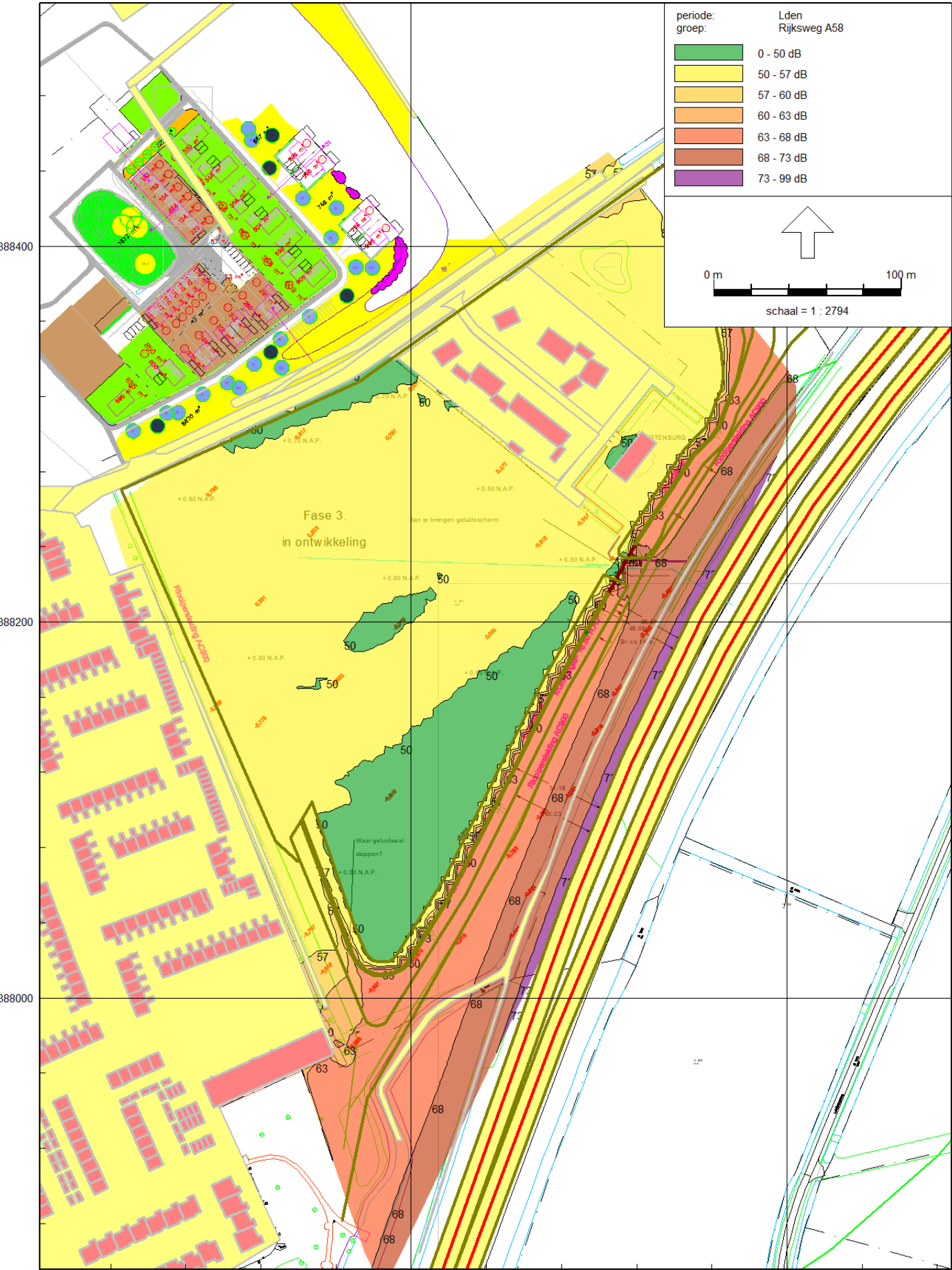
Wegverkeerslawaaï - RMW-2012, [20197377 - Palts Oost-Souburg - V4b - geluidswal en scherm hoogte 10,0 meter - geluidswal aan zuidzijde verlengd - 50 meter], Geomilieu V5.10
