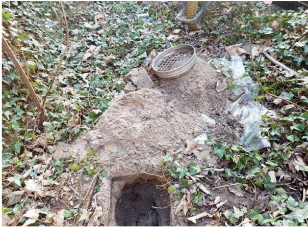
Fotonummer: 1 Omschrijving: Proefgat 102a inclusief uitgegraven materiaal.
