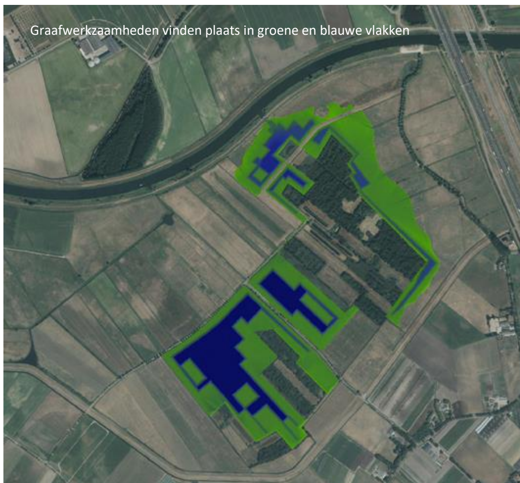
Figuur 13: Op de percelen waar rietmoeras (groen) wordt gerealiseerd wordt bovengrond afgegraven. Op de percelen waar open water (blauw) wordt gerealiseerd wordt bovengrond en het onderliggende veen afgegraven. De profielen zijn te zien in figuur 7.
