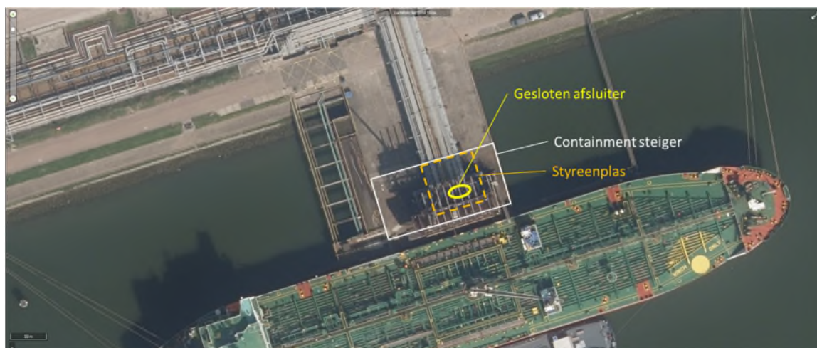
Figuur 3-11 lekkage onder pompdruk – ontstane styreenplas (oranje gestippeld omkaderd)
