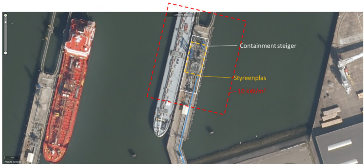
Figuur 3-4 Lekkage onder pompdruk – warmtestralingscontouren (rode stippellijn) van ontstane styreenplas (oranje gestippeld omkaderd).
