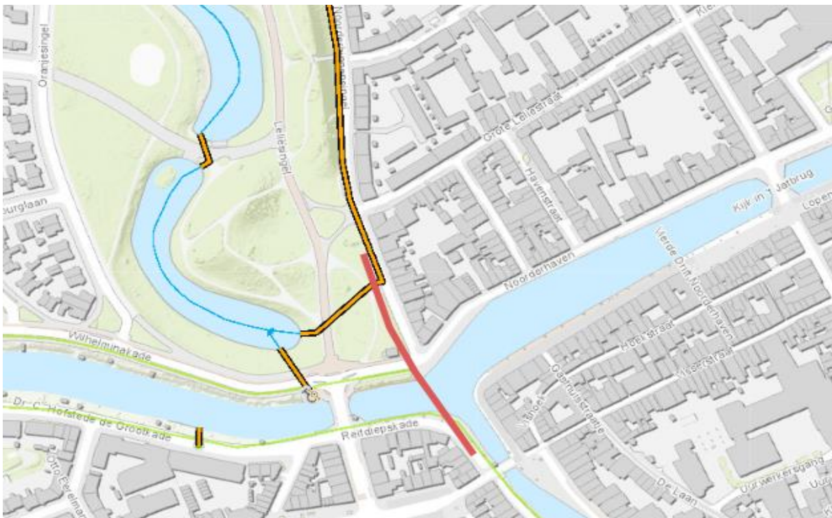
Figuur 1: Overzicht met in het groen de ligging van de waterkeringen en in het rood globaal de boorlijn. De oranje lijnen geven de ligging van duikers aan.
