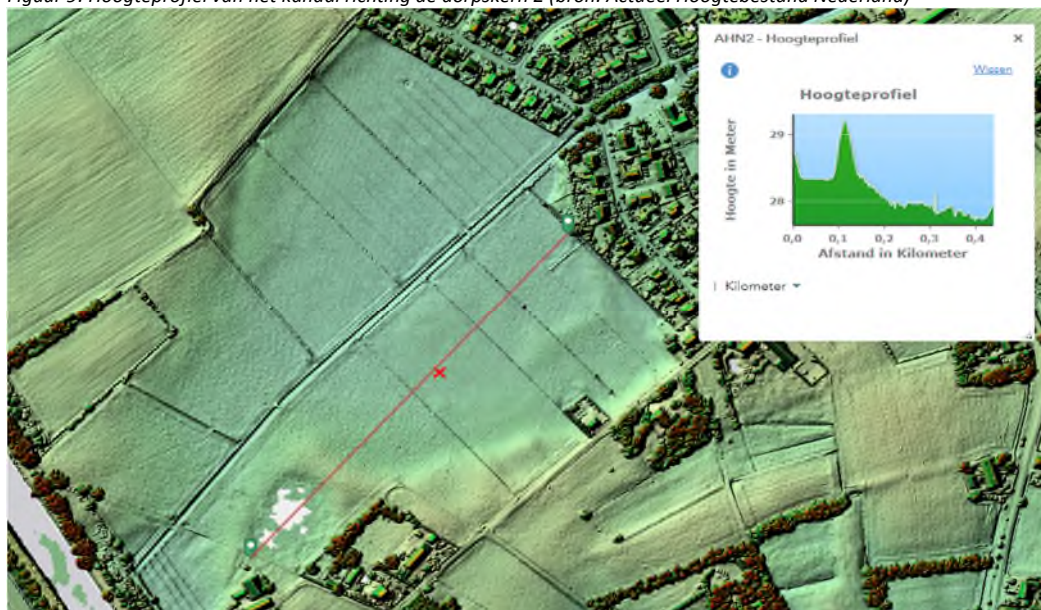
Figuur 9: Hoogteprofiel van het kanaal richting de dorpskern 2 (bron: Actueel Hoogtebestand Nederland)
