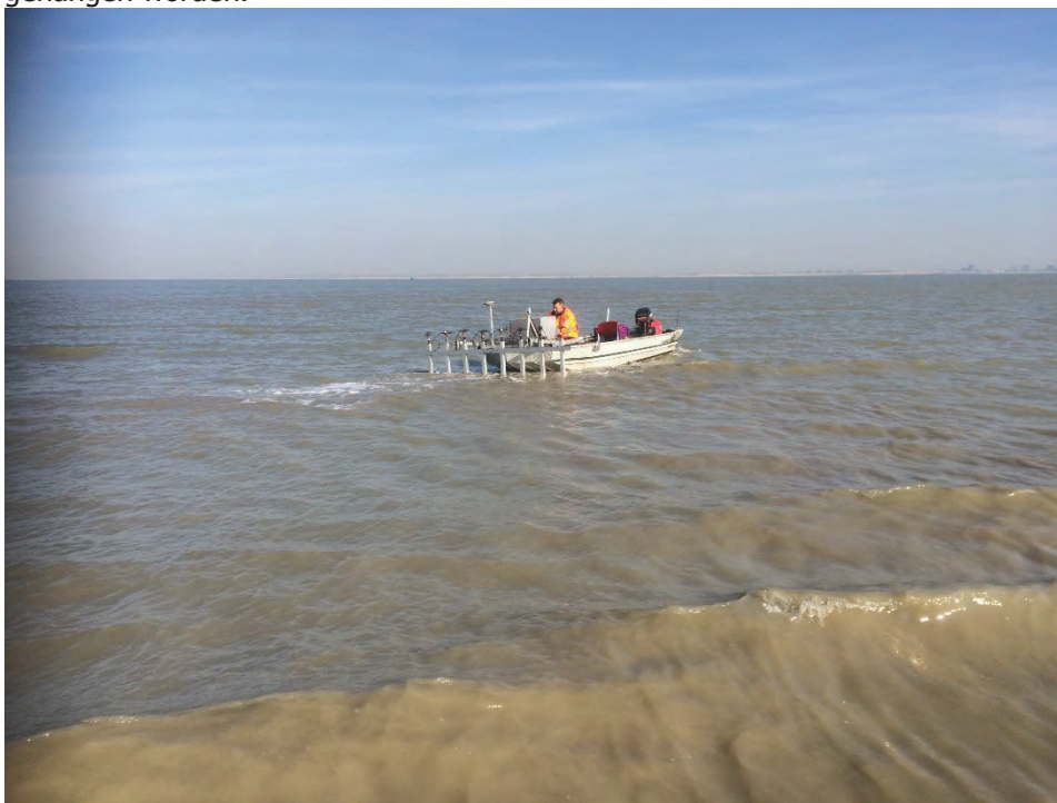
Figuur 5. Passieve NON realtime waterbodemdetectie m.b.v. het Vallon multisondesysteem VXV8 gemonteerd voor de detectieboot.
