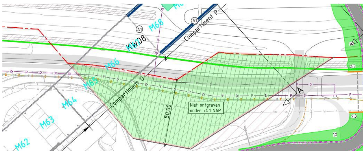
Figuur 2: Voorland niet ontgraven
