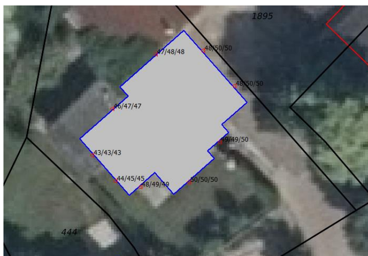
Afbeelding 3: Overzicht gecumuleerde geluidbelasting op het bouwplan (excl. aftrek Wgh)
