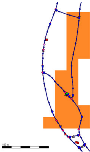
Figuur 16 rekenraster dat is verhoogd om onbedoelde stroming over het maaiveld te voorkomen.
