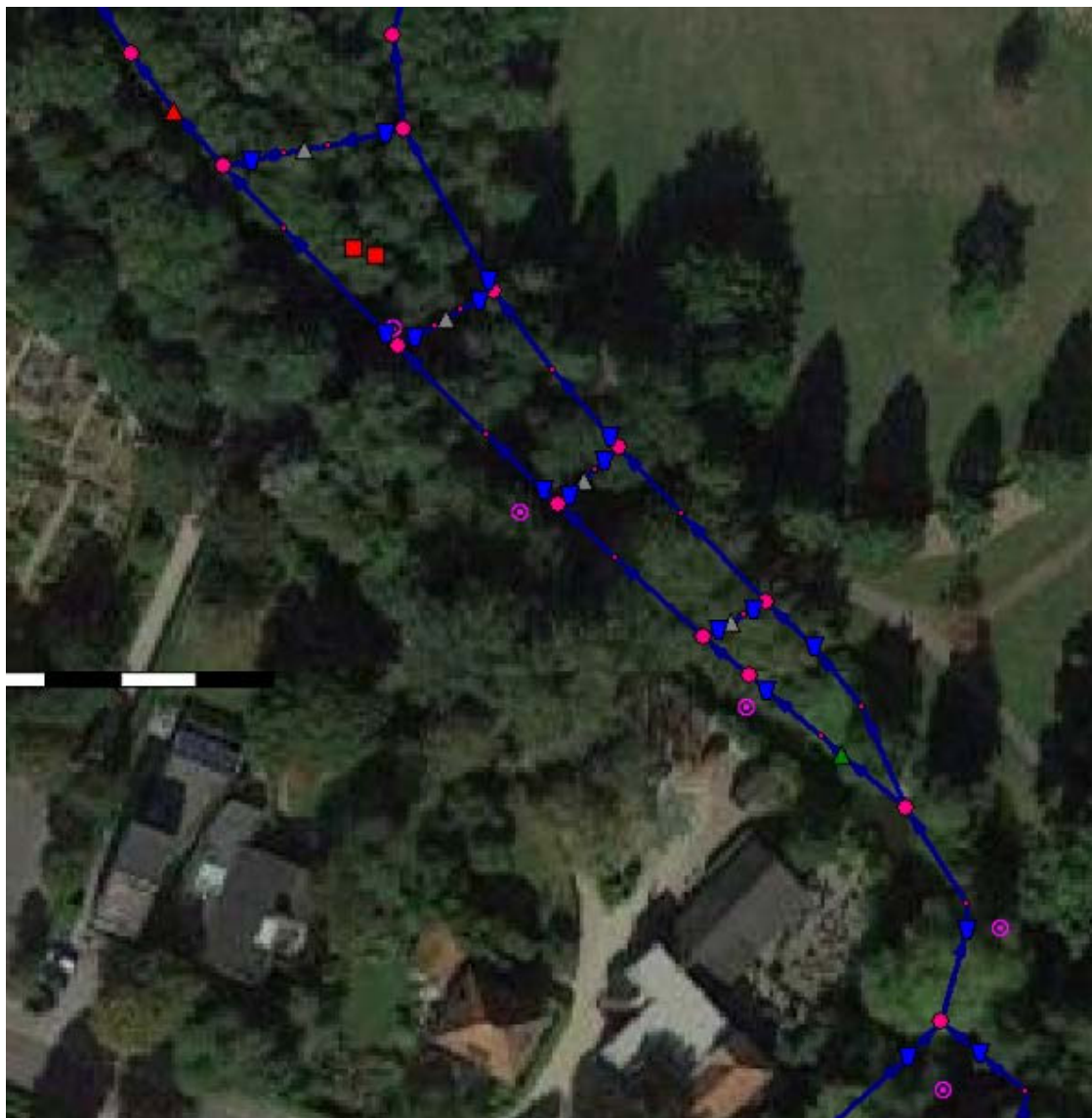
Figuur 15 De drempel is geschematiseerd als een viertal parallel liggende takjes met op elk daarvan een Universal Weir.
