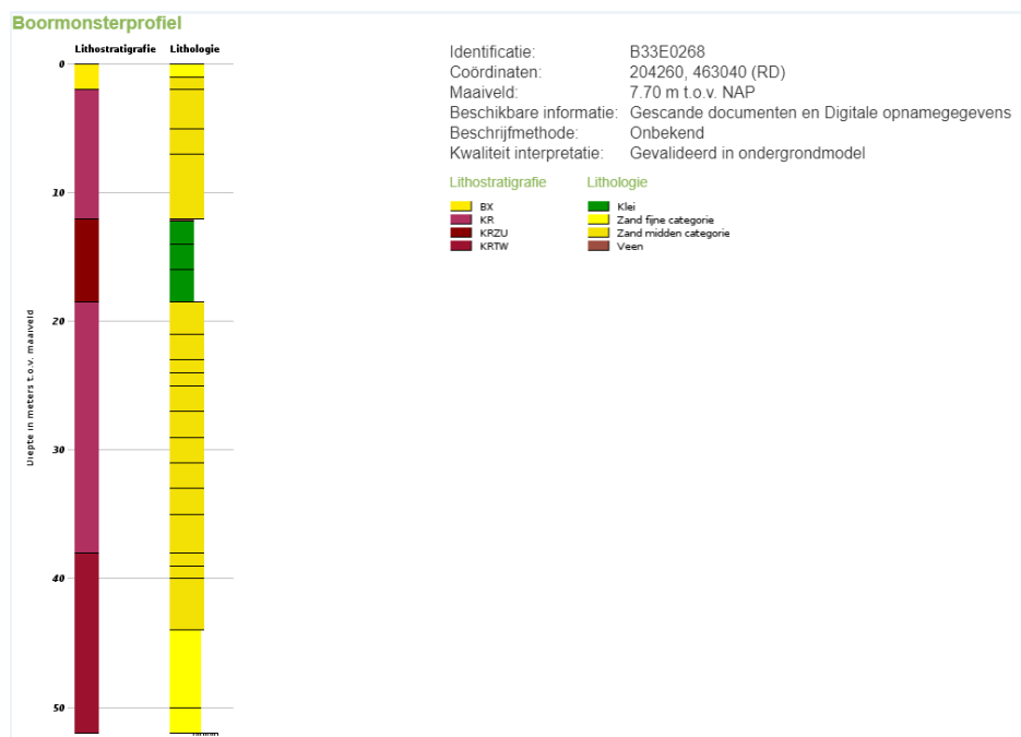
Afbeelding 2.1: Boorprofiel boring B33E0268
