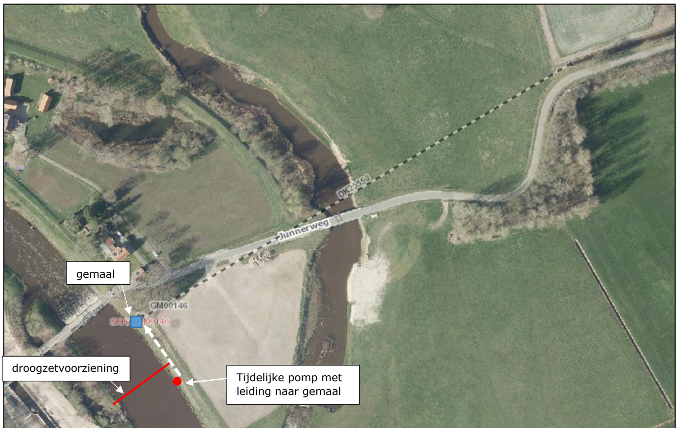
Figuur 19: Ligging gemaal en pomp tijdens werkzaamheden.
