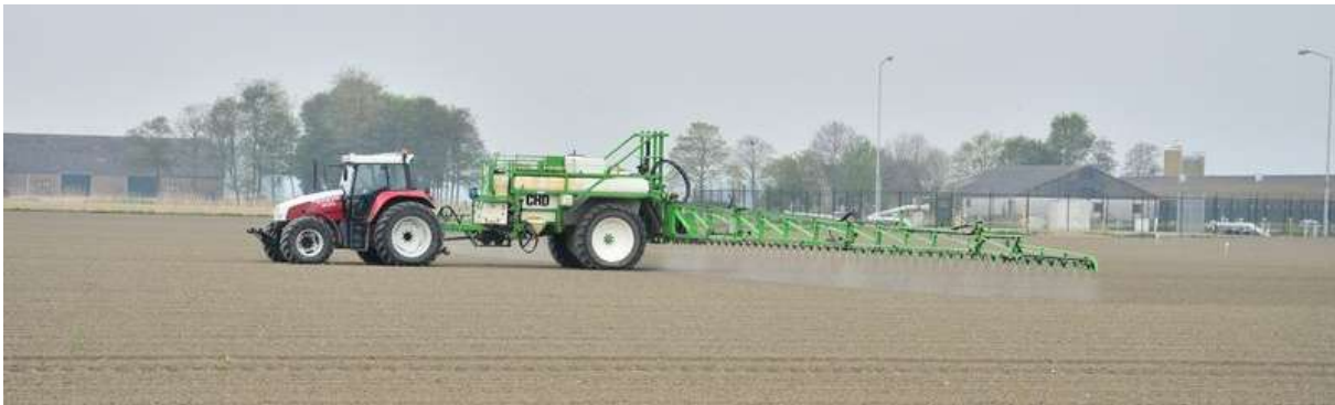
Foto 5. Veldspuit met aanvullende driftreducerende voorziening -> veldspuit + luchtondersteuning
