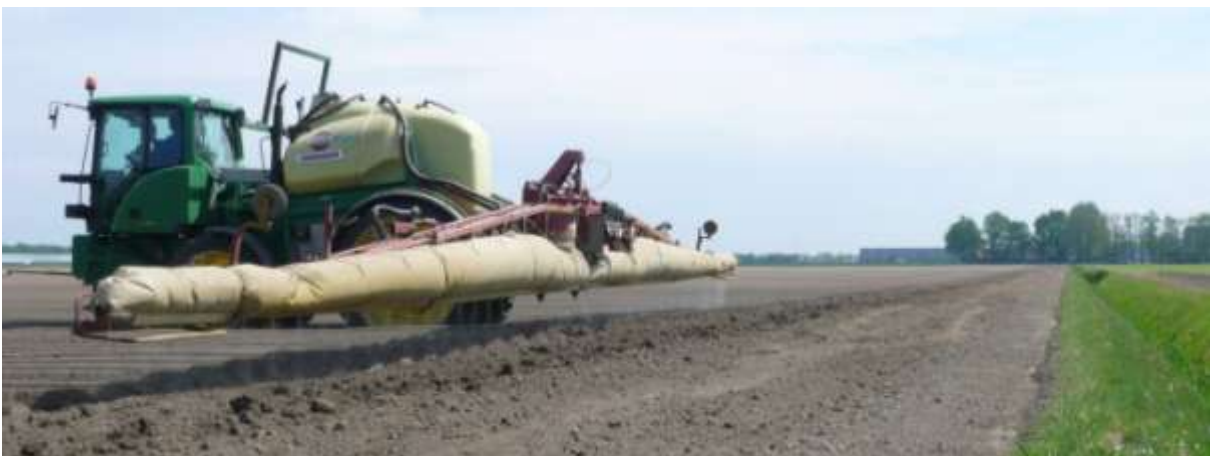
Foto 5. Veldspuit met aanvullende driftreducerende voorziening -> veldspuit + luchtondersteuning
