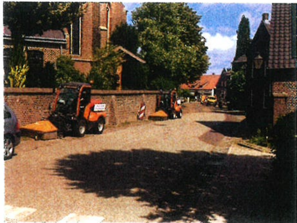
Figuur 8: onkruidbestrijding op verharding met hete lucht..
