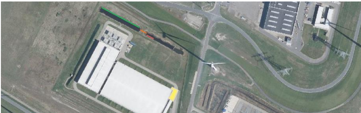
Figuur 2: met in het geel: de geplande uitbreiding, rood: de in te korten watergang, oranje: de te verlengen duiker en groen: de te verbreden watergang.
