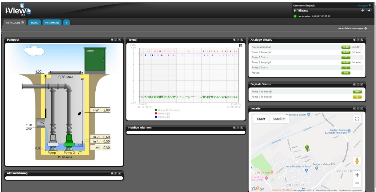
Afbeelding 4.12: Via het gemalenbeheersysteem kan op afstand worden ingegrepen (bron: gemeente Bergelijk)
