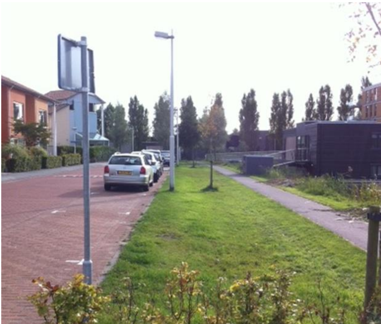
Afbeelding 4.1: Holle bermen voor de opvang van afstromend regenwater (bron: gemeente Bergeijk)
