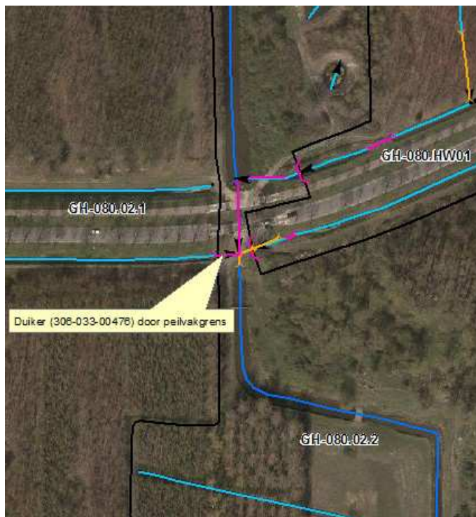
Figuur 5.1: Duiker door peilscheiding GH-080.02.1 en GH-080.02.2
