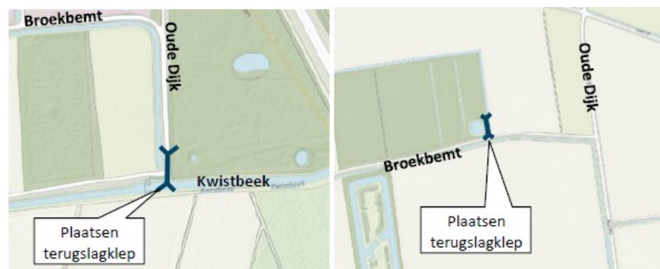
Figuur 4-9: Locaties terugslagkleppen op duikers in de Broekbemt
