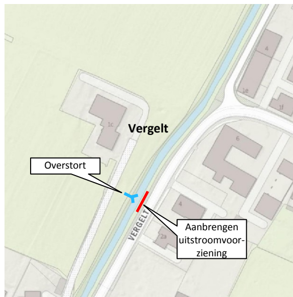
Figuur 4-37: Principe aanbrengen uitstroomvoorziening overstort
