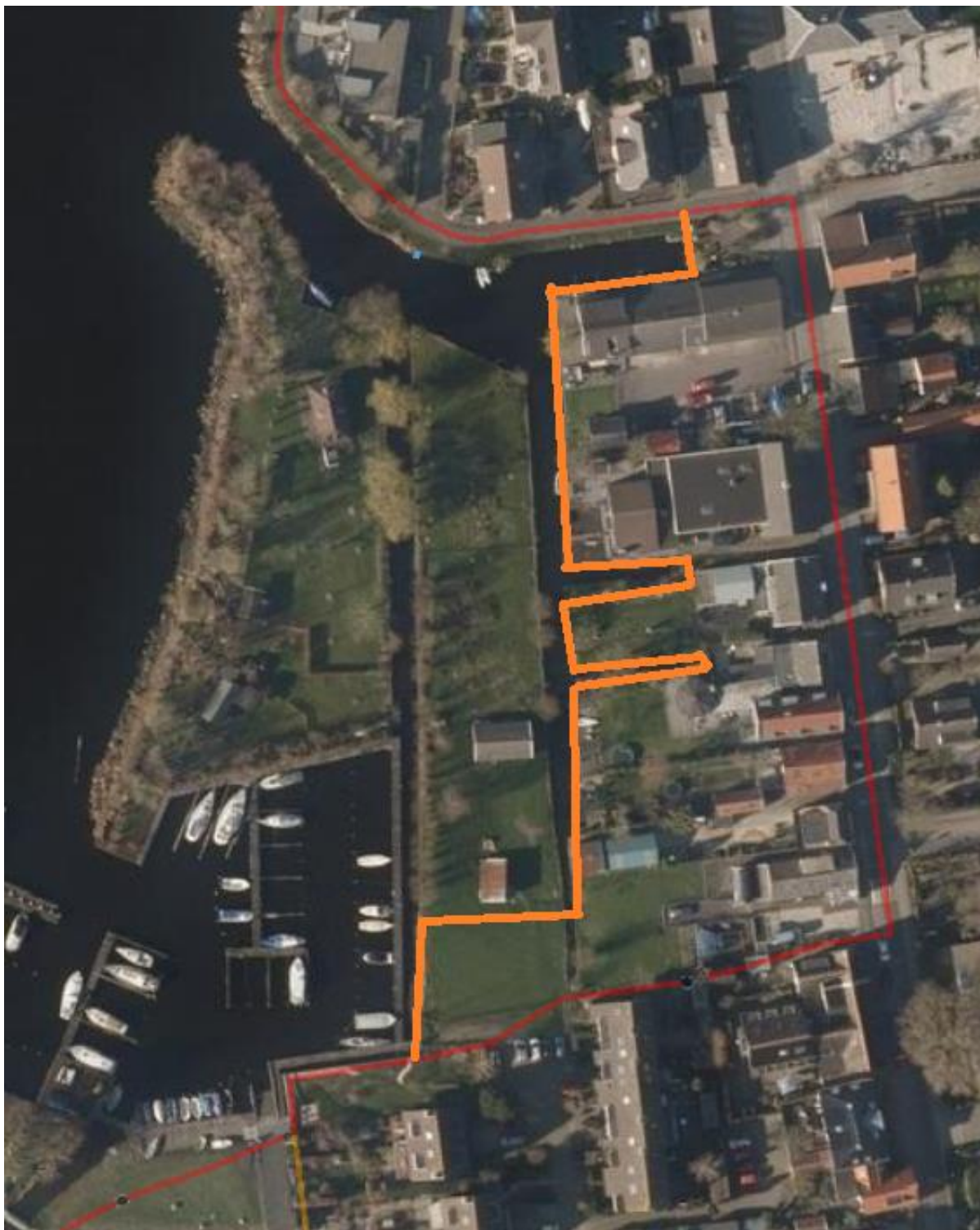
Figuur 3-2: Luchtfoto (2017) met vigerende Legger (rode lijn) en nieuwe vast te stellen Leggerlijn (oranje) waardoor dit werk projectplanplichtig is. Woningen komen zo binnendijks te liggen.
