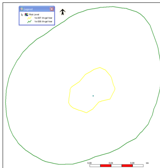
Figuur 7 Plaatsgebonden risico voorbeeldberekening
