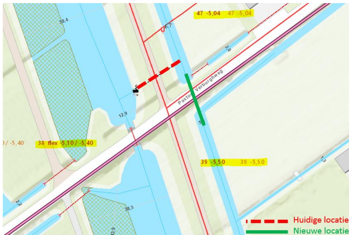
Figuur 1: bovenaanzicht Pastoor Verburghweg met huidige en nieuwe locatie van pompje inclusief persleiding
