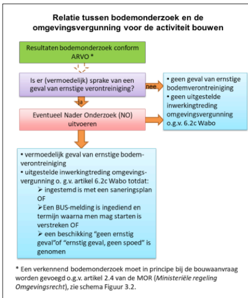
Figuur 3.3 Relatie tussen uitkomsten bodemonderzoek en de omgevingsvergunning voor de activiteit bouwen
