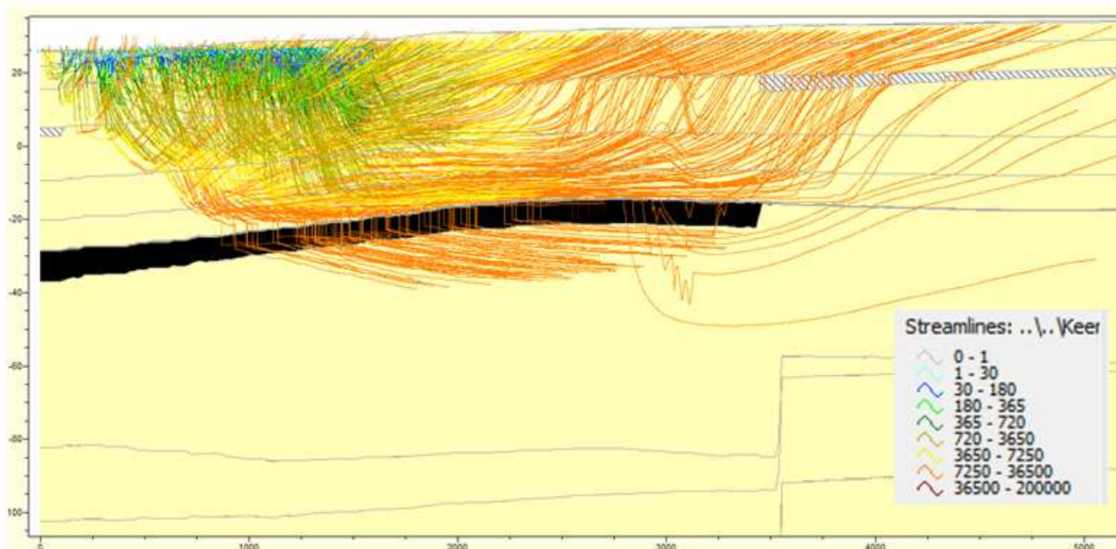
Figuur 8: W-O doorsnede door Keersop Midden. De berekende stroombanen voor een stationaire situatie zijn ingekleurd naar reistijd in dagen. Aquifers zijn voorgesteld in geel, aquitards met zwarte vlakken
