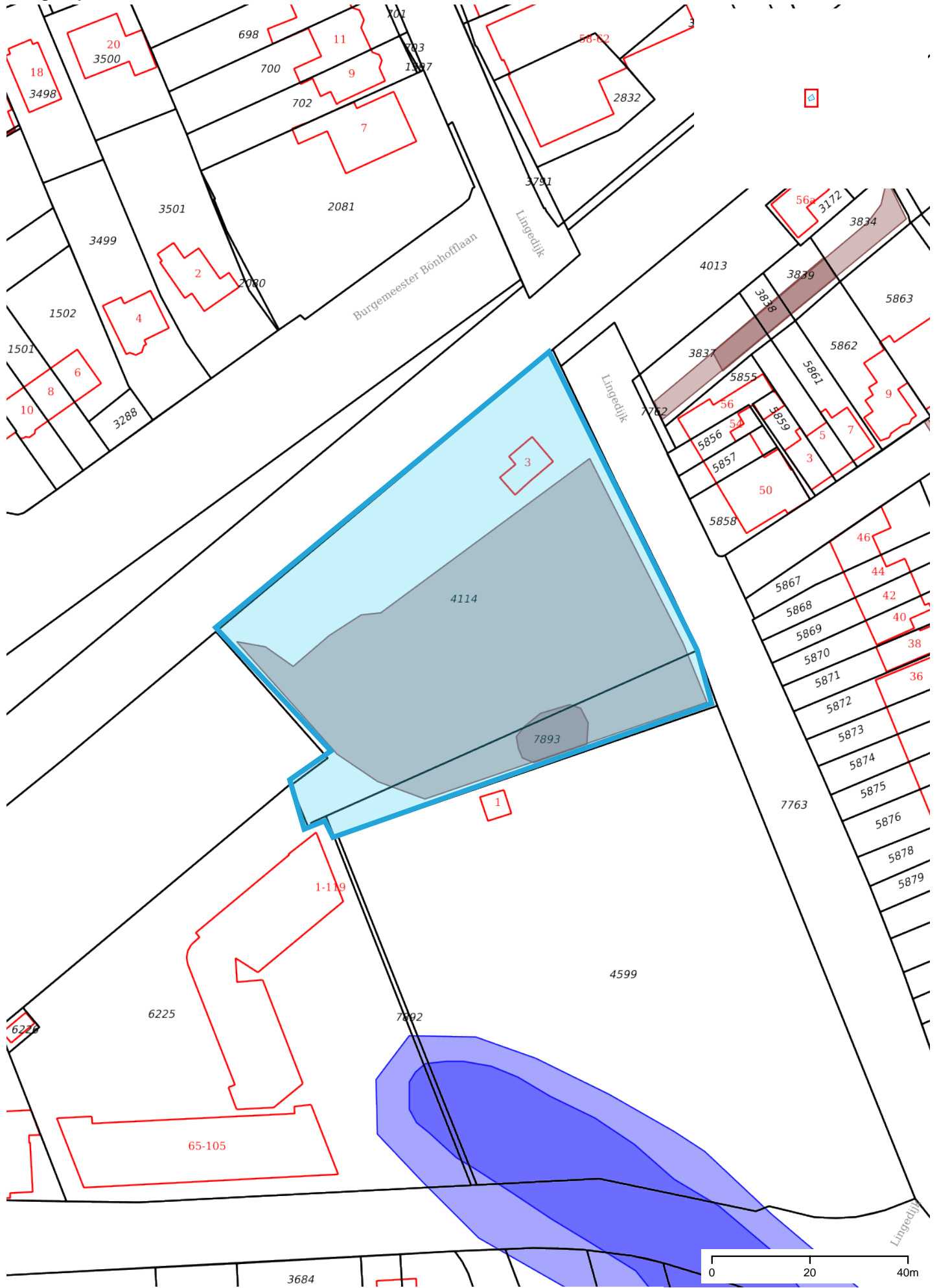
I-contouren grond asbest (klein) en PAK/zware metalen (groot)
