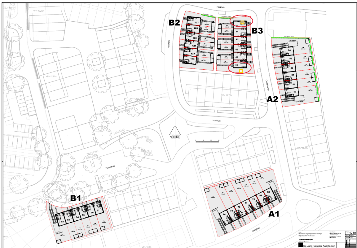
Figuur 4 Locatie van geschikte gevels voor vleermuizen in nieuwbouw (Rode cirkels). Afmeting alternatieven Woningen: de diepte van de houten betimmeringen in de kopgevels is 31 mm. De breedte en hoogte van deze betimmeringen zijn circa 80 cm. Per kopgevel komen 2 van dergelijke betimmeringen, 4 in totaal. Elke 'gevelkast' krijgt toegang via twee open stootvoegen van 2,5 cm breed. Als extra voorschrift is opgenomen dat deze een lengte van minimaal 5 cm dienen te hebben.
