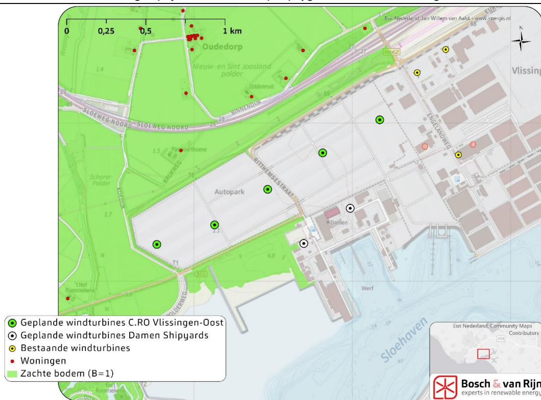
Figuur 2 Bodemabsorptie en –reflectie rondom het windpark. Bron: Bestand Bodemgebruik 2012. Standaard is gerekend met een harde, reflecterende bodem ( B=0 ). Gebieden met een zachte bodem (groen in onderstaande figuur) zijn als absorberend ( B=1 ) opgenomen in de berekening.
