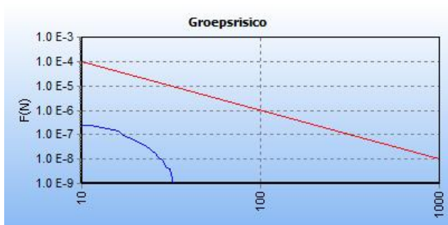
Figuur 9: De fN-curve voor deze kilometer leiding (leiding Z-567-01 exclusief de twee windturbines).
