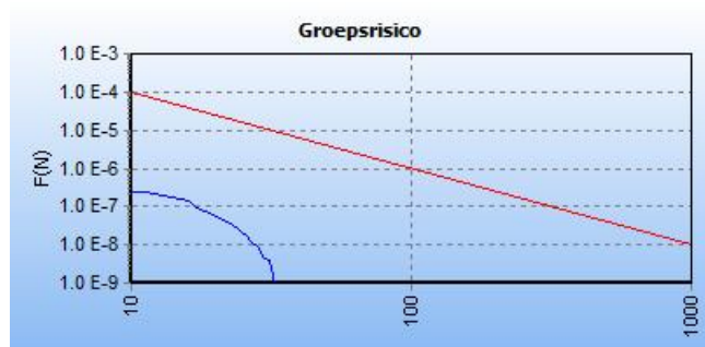
Figuur 12: De fN-curve voor deze kilometer leiding (leiding Z-567-01 inclusief de twee windturbines).
