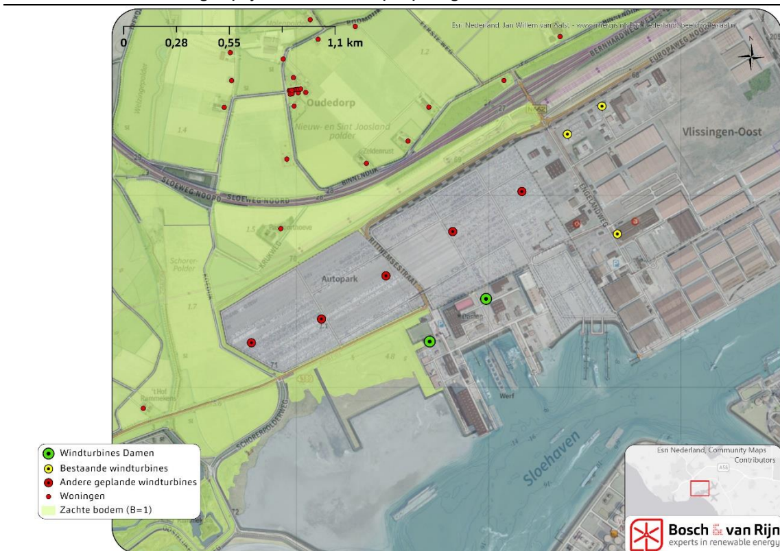
Figuur 2 Bodemabsorptie en –reflectie rondom het windpark. Bron: Bestand Bodemgebruik 2012. Standaard is gerekend met een harde, reflecterende bodem. Gebieden met een zachte bodem (groen in onderstaande figuur) zijn als absorberend ( B=1 ) meegenomen.
