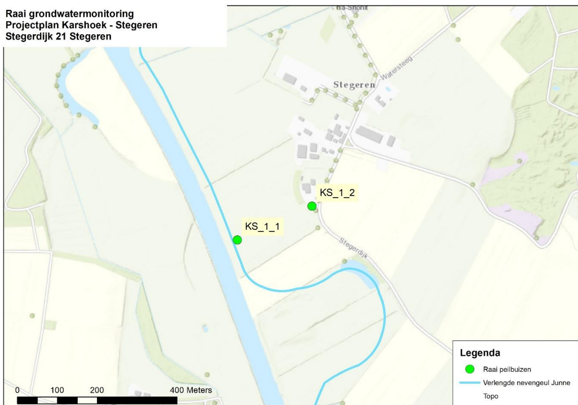
Figuur I-12 Kaart van de locatie van de geplaatste peilbuizen ten behoeve van extra monitoring van de lokale grondwaterstanden
