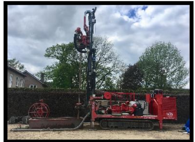
Afbeelding 1 & 2: Boorwagen opgesteld met bak voor losgekomen grond.
