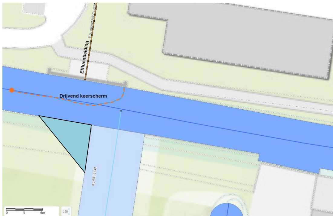
Figuur I-3 Schets van mogelijke maatregel om effluentwater ‘rechtsaf te leiden’, met behulp van een drijvend keerscherm.
