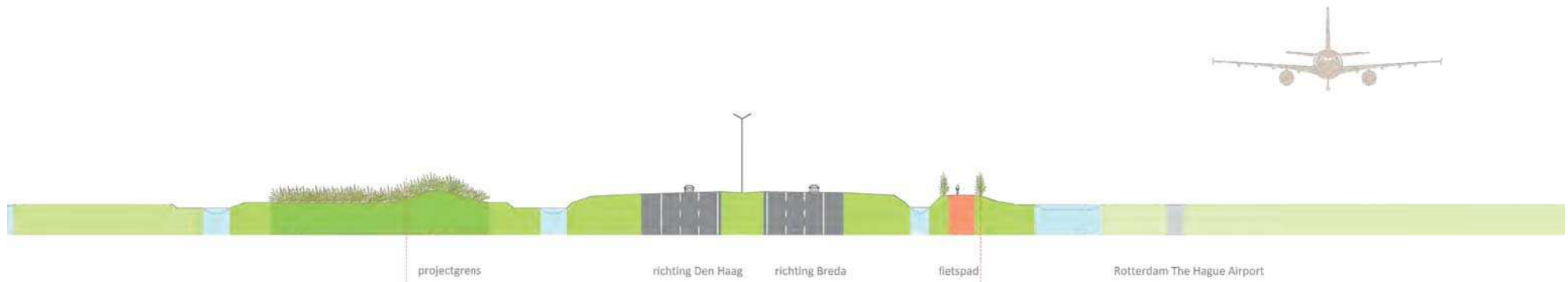
Doorsnede AA: segment Zestienhoven-polder Schieveen, weg op aarden baan
