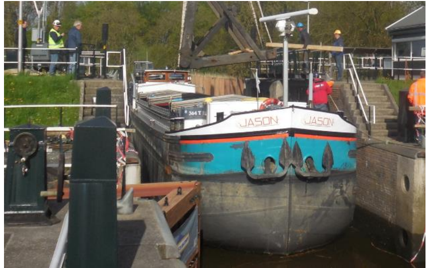
Spits (schip) maximale diepgang 1,50 m
