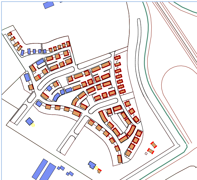
Afbeelding 2 gevels met geluidbelasting > 48 dB op de tweede verdieping (A2)
