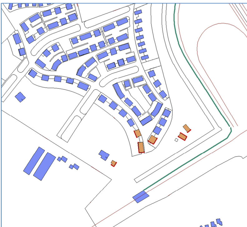
Afbeelding 4 Gevels met geluidbelasting > 48 dB op de eerste verdieping (Ringweg)
