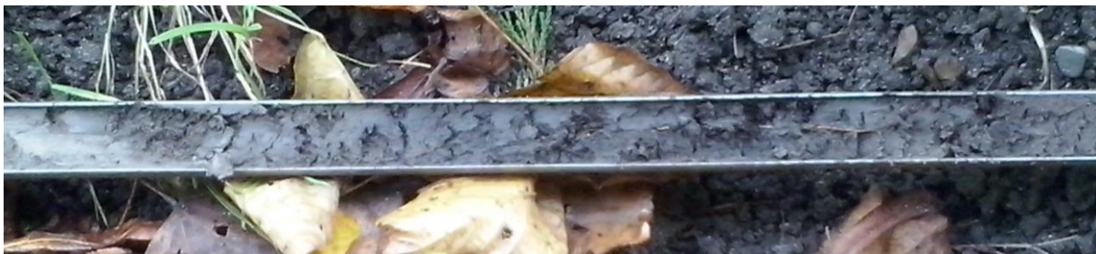
Figuur 3: Foto van boring 1 met de overgang van zandige klei (links) naar zwak humeuze klei (rechts).
