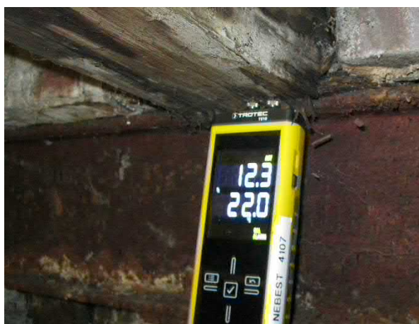
Figuur 4.11: Vochtpercentage boven linker deur
