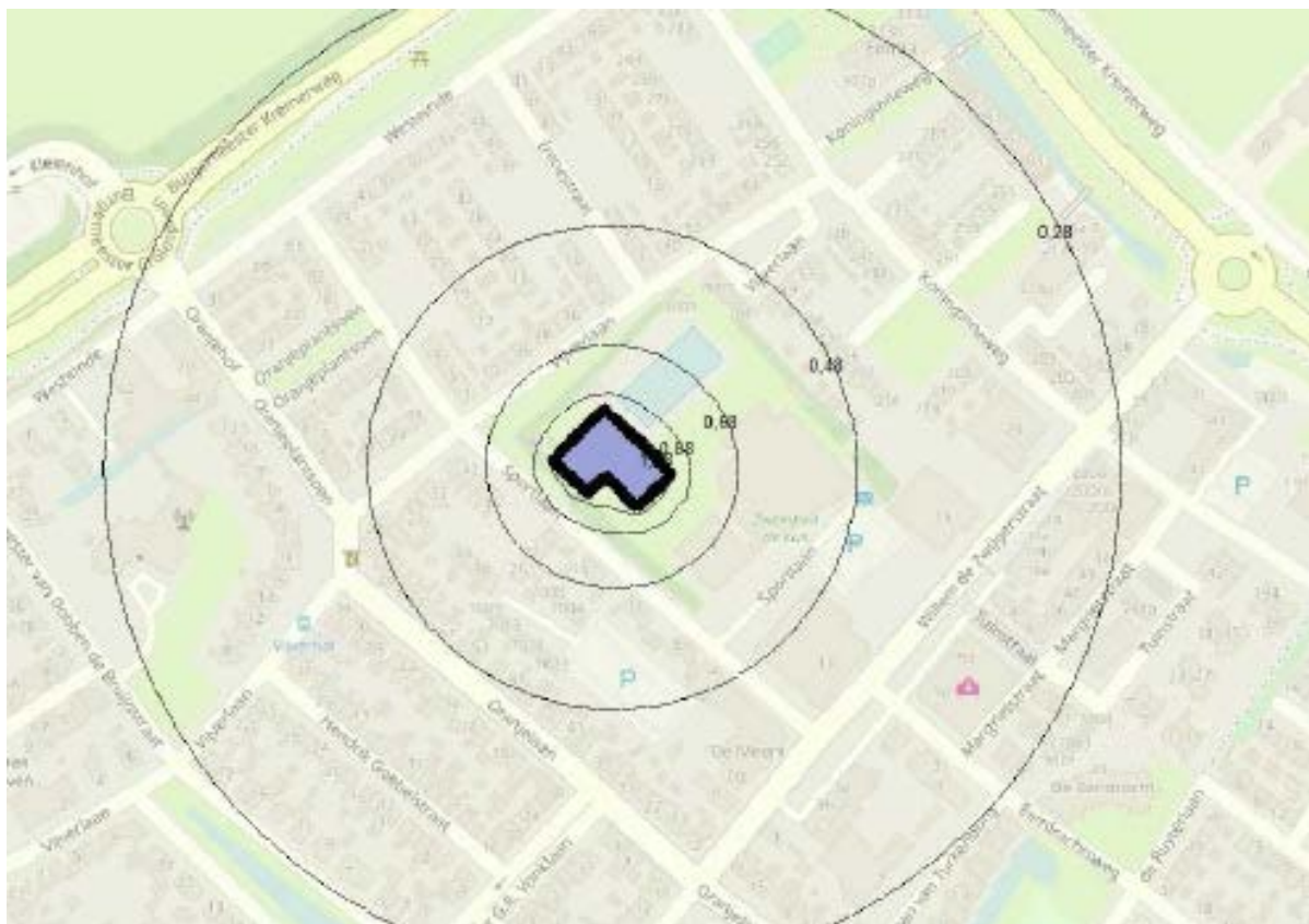
Verlaging in de omgeving bij bemaling bij GLG
