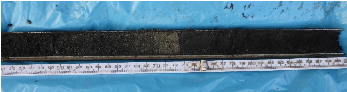
Overgang van het opgebrachte zandpakket naar het veraarde Hollandveen (boring 10).
