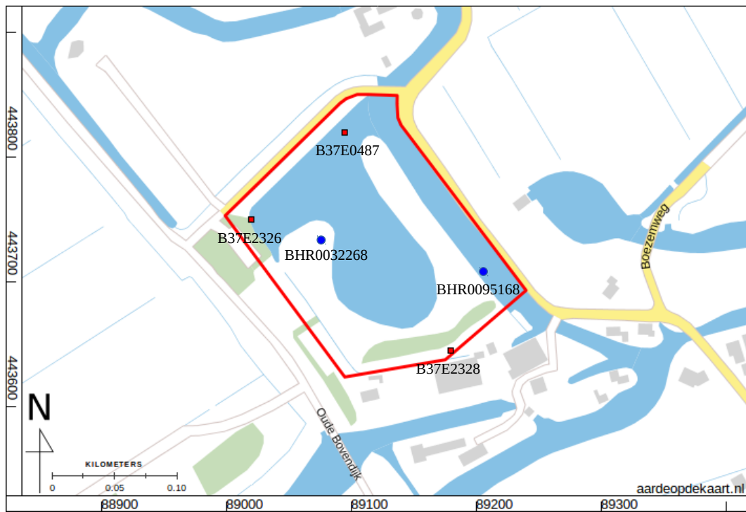
Figuur 16: Reeds uitgevoerde booronderzoeken in het plangebied (Dinoloket 2014). Geologisch onderzoek is weergegeven in rode vierkanten; bodemkundig onderzoek is weergegeven in blauwe cirkels.
