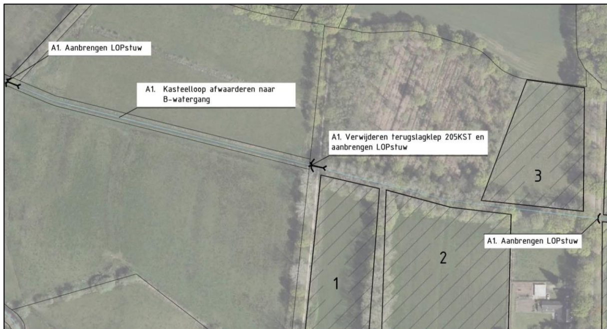
Figuur 3.3 Overzicht maatregelen kasteelloop West
